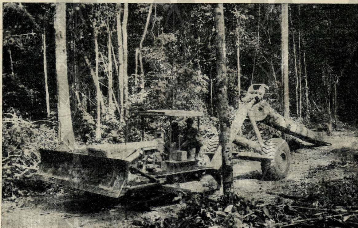
S.T.P.F. — Seção de Exploração Florestal — Operação de arraste com trator D-6 e "logging arch". Reserva do Palhão
